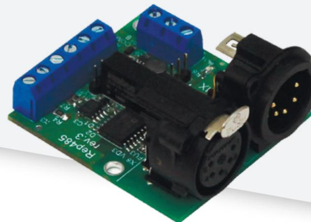
Carte OEM pour l'intégration dans les installations et équipements de tiers. La carte IsoGate est capable d'amplifier le signal DMX512 ou d'autres signaux basés sur la physique RS485.
