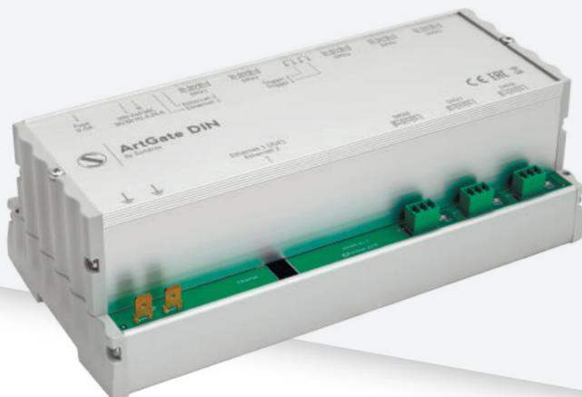
Nodes multifonctionnels montés sur DIN qui traduisent les protocoles Ethernet (ArtNet, sACN) en DMX pour contrôler plus d'installations lumineuses par le biais d'une seule liaison Ethernet LAN 10/100BaseT. Les entrées de déclenchement permettent de lancer des scénarios DMX préprogrammés lorsque des déclencheurs (par exemple, une alarme incendie) sont activés, même si la console est en panne.
