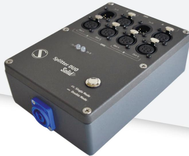
Le Splitter Duo Solid est une interface avec 2 entrées DMX et 4 sorties DMX qui fonctionne comme un splitter normal avec 1 entrée et 5 sorties ou comme deux splitters 1to2 séparés. Tous les canaux d'entrée et de sortie disposent d'une isolation galvanique complète. Compatible avec la gestion à distance des appareils (RDM).
