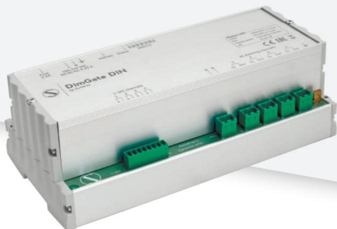
DimGate DIN est un gradateur hybride sur rail DIN qui convertit le signal DMX512 en 4 sorties 110/230 VAC indépendantes pouvant atteindre 1,2 kW chacune pour gérer la luminosité des lampes à incandescence. Quatre sorties 110V (ou 010V) supplémentaires sont fournies séparément pour intégrer des appareils avec des pilotes de gradation 110V et des ballasts électroniques dans des environnements contrôlés par DMX.
