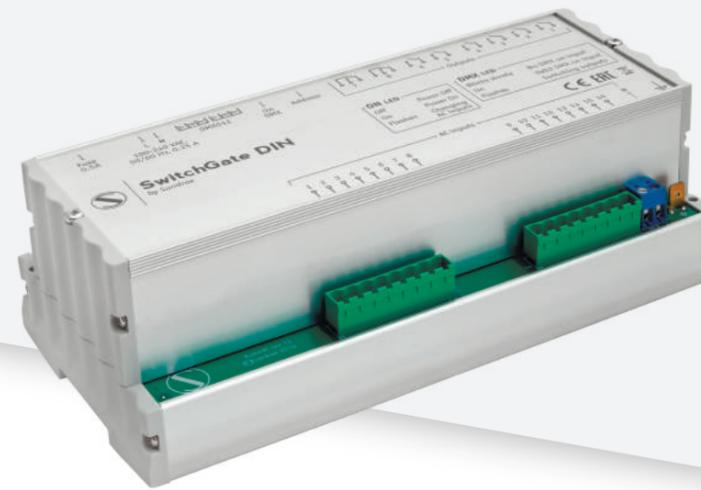
SwitchGate DIN est un commutateur DMX à fonctionnalité améliorée. Capable d'activer et de désactiver 8 circuits d'alimentation par des commandes DMX, l'appareil fournit un retour de diagnostic de jusqu'à 16 entrées AC via une communication RDM standard. Monté sur rail DIN standard, SwitchGate fonctionne dans les réseaux électriques sans aucun composant intermédiaire.
