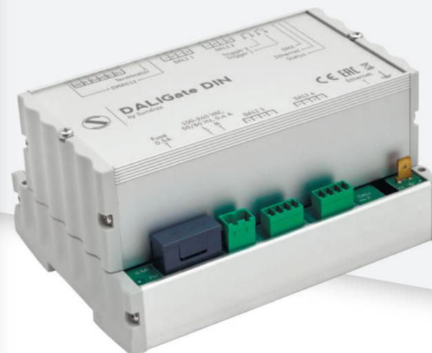
DALIGate DIN est un node monté sur rail DIN qui convertit le signal ArtNET/sACN/DMX en protocole DALI pour inclure les luminaires DALI dans un réseau d'éclairage contrôlable. Grâce au montage sur rail DIN et à l'entrée ArtNET/sACN/DMX, DALIGate DIN est idéal comme solution d'intérieur pour le contrôle de l'éclairage mixte dans les théâtres, les petites salles, les installations architecturales, l'éclairage industriel, les entrepôts et les installations agricoles.
