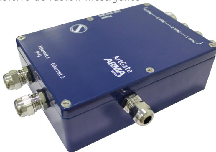
ArtGate es una serie de dispositivos multifuncionales para la conversión bidireccional DMX512-ArtNet/sACN. Las corrientes de datos DMX512 que recibe ArtGate Arma se transmiten a través de la red Ethernet LAN en modo 10/100 Base-T y viceversa. La compatibilidad con los protocolos ArtNet y sACN facilita la incorporación de ArtGates en redes compuestas por dispositivos de otros fabricantes.
