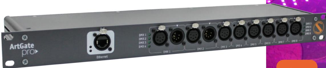
ArtGate es una serie de dispositivos multifuncionales para la conversión bidireccional DMX512-ArtNet/sACN. Las corrientes de datos DMX512 que recibe ArtGate Pro se transmiten a través de la red Ethernet LAN en modo 10/100 Base-T y viceversa. La compatibilidad con los protocolos ArtNet y sACN facilita la incorporación de ArtGates en redes compuestas por dispositivos de otros fabricantes.
