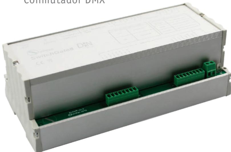
SwitchGate DIN es un conmutador DMX de funcionalidad mejorada. Capaz de apagar y encender 8 circuitos de potencia con comandos DMX, este dispositivo proporciona un diagnóstico de hasta 16 entradas AC a través de una comunicación RDM estándar. De montaje en carril DIN estándar, SwitchGate opera en redes eléctricas sin componentes intermediarios.
