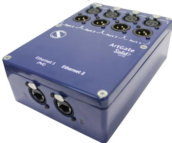
ArtGate es una serie de dispositivos multifuncionales para la conversión bidireccional DMX512-ArtNet/sACN. Las corrientes de datos DMX512 que recibe ArtGate Solid se transmiten a través de la red Ethernet LAN en modo 10/100 Base-T y viceversa. La compatibilidad con los protocolos ArtNet y sACN facilita la incorporación de ArtGates en redes compuestas por dispositivos de otros fabricantes.
