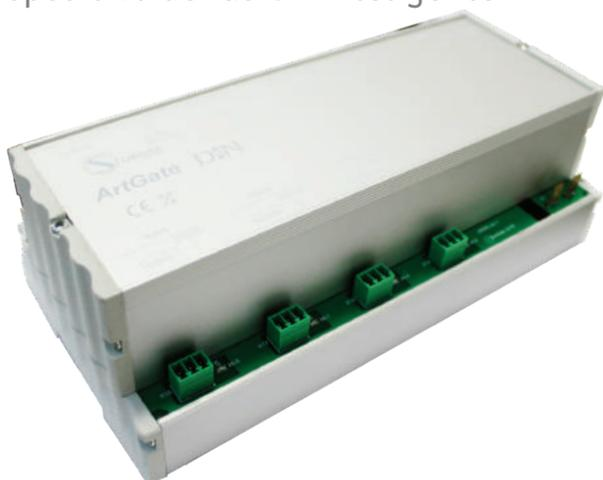
ArtGate es una serie de dispositivos multifuncionales para la conversión bidireccional DMX512-ArtNet/sACN. Las corrientes de datos DMX512 que recibe ArtGate DIN se transmiten a través de la red Ethernet LAN en modo 10/100 Base-T y viceversa. La compatibilidad con los protocolos ArtNet y sACN facilita la incorporación de ArtGates en redes compuestas por dispositivos de otros fabricantes.
