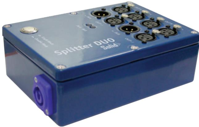
El Splitter Solid DUO es un dispositivo especial con 2 entradas y 4 salidas DMX que opera como un duplicador normal con una entrada y 5 salidas así como dos duplicadores 1 a 2 separados. Todos los canales de entrada y salida disponen de aislamiento galvánico. Compatible con herramientas de Administración de Dispositivos Remotos (RDM). El dispositivo es apto para uso interior. Los Splitters están alimentados por una red industrial AC de 100-250V y consume menos de 5 vatios de potencia.
