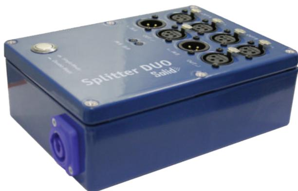
Splitter con modalità Input singolo/doppio Lo Splitter Solid DUO è un dispositivo speciale con 2 input e 4 output DMX che opera come un normale splitter con 1 input e 5 output oppure come due splitter da 1 input e 2 output separati. Tutti i canali input e output sono provvisti di isolamento galvanico. Compatibile con sistemi di gestione remota (RDM). Il dispositivo è adatto all'uso interno. Lo Splitter è alimentato da una rete industriale AC da 100-250V e consumano meno di 5 Watt.
