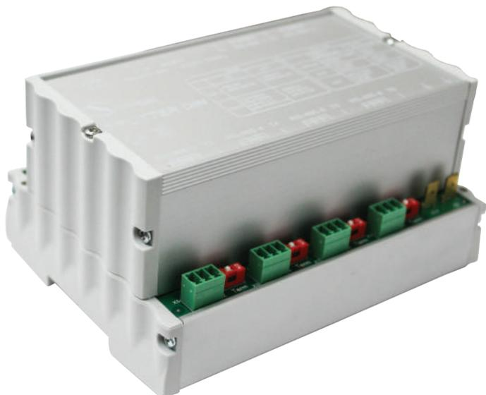
Lo Splitter DIN DUO è un dispositivo speciale montabile su binario DIN con 6 porte input/output DMX che opera come un normale splitter con 1 input e 5 output oppure come due splitter da 1 input e 2 output separati. Tutti i canali input e output sono provvisti di isolamento galvanico. Dispositivo remoto Compatibile con sistemi di gestione remota (RDM). Il dispositivo è adatto all'uso interno. Lo Splitter è alimentato da una rete industriale AC da 100-250V e consumano meno di 5 Watt.
