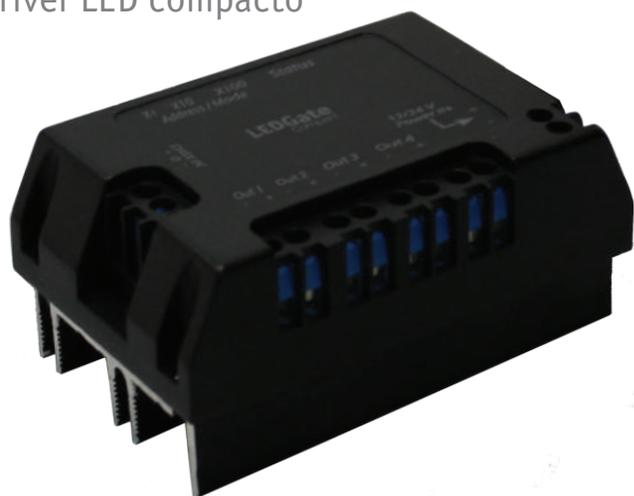
LEDGate Compact è un driver LED compatto con input DMX512. Alimentato da VDC 12/24, LEDGate può dimmerare 2 o 4 linee output per connessione diretta a dispositivi LED (duralight, luminarie LED driverless, etc.) con protezione da corto circuito indipendente per ogni canale. Grazie agli innovativi algoritmi integrati, i LEDGates offrono una regolazione stabile e progressiva a qualsiasi livello di intensità.
