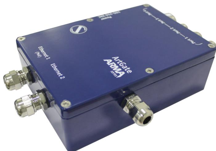
ArtGate è una serie di dispositivi multifunzionali per la conversione bi-direzionale DMX512-ArtNet/sACN. Il flusso dati DMX512 ricevuto da ArtGate viene trasmesso via Ethernet LAN in 10/100 Base-T e viceversa. La compatibilità con i protocolli ArtNet e sACN facilita l'integrazione di ArtGate in reti contenenti dispositivi di altri produttori.
