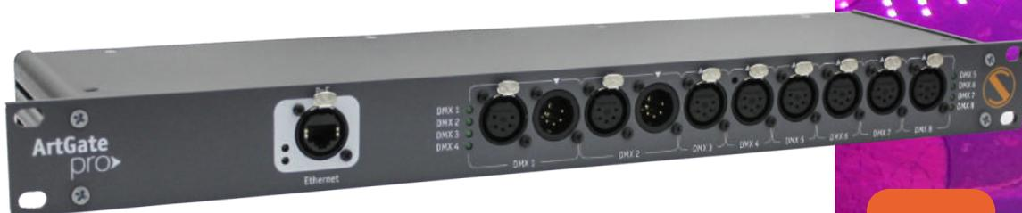
ArtGate è una serie di dispositivi multifunzionali per la conversione bi-direzionale DMX512-ArtNet/sACN. Il flusso dati DMX512 ricevuto da ArtGate Pro viene trasmesso via Ethernet LAN in 10/100 Base-T e viceversa. La compatibilità con i protocolli ArtNet e sACN facilita l'integrazione di ArtGate in reti contenenti dispositivi di altri produttori.
