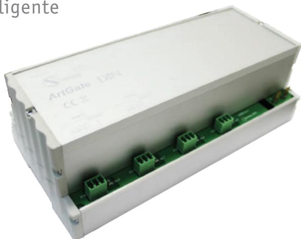
ArtGate è una serie di dispositivi multifunzionali per la conversione bi-direzionale DMX512-ArtNet/sACN. Il flusso dati DMX512 ricevuto da ArtGate DIN viene trasmesso via Ethernet LAN in 10/100 Base-T e viceversa. La compatibilità con i protocolli ArtNet e sACN facilita l'integrazione di ArtGate in reti contenenti dispositivi di altri produttori.
