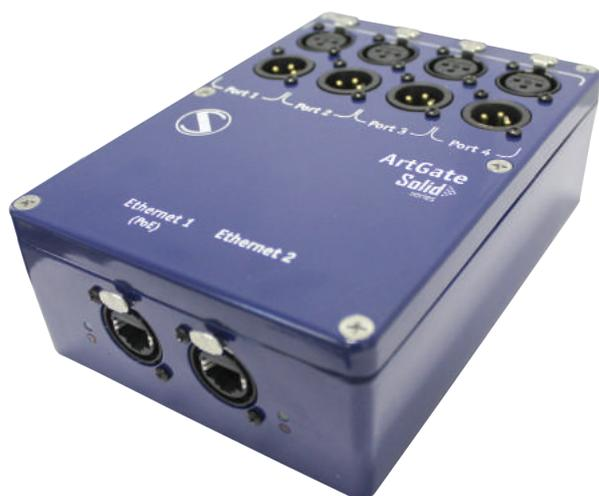
ArtGate è una serie di dispositivi multifunzionali per la conversione bi-direzionale DMX512-ArtNet/sACN. Il flusso dati DMX512 ricevuto da ArtGate viene trasmesso via Ethernet LAN in 10/100 Base-T e viceversa. La compatibilità con i protocolli ArtNet e sACN facilita l'integrazione di ArtGate in reti contenenti dispositivi di altri produttori.
