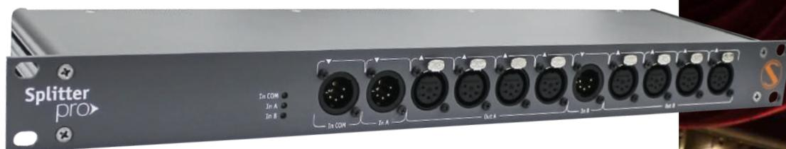
Lo Splitter DUO PRO è un dispositivo speciale con 3 input DMX e 8 output DMX che opera come un normale splitter con 1 input e 8 output oppure come due splitter da 1 input e 4 output con opzione di riserva. Tutti i canali input e output sono provvisti di isolamento galvanico. Compatibile con sistemi di gestione remota (RDM). Il dispositivo è adatto per uso interno e montaggio su rack. Gli splitter sono alimentati da una rete industriale AC da 100-250V e consumano meno di 5 Watt.
