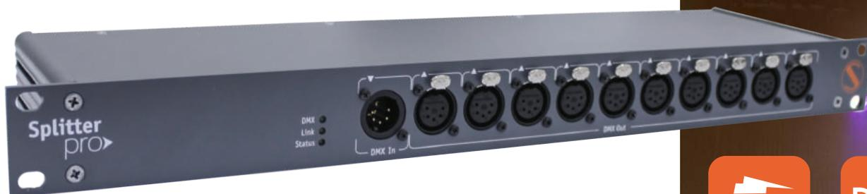
Splitter PRO è una serie di splitter multifunzione montabili su rack progettati per le reti DMX di dimensioni maggiori, in grado di potenziare il segnale per creare una rete di 5 o 10 linee DMX aggiuntive dall'input DMX. Tutti i canali input e output sono provvisti di isolamento galvanico. Compatibile con sistemi di gestione remota (RDM). Il dispositivo è adatto all'uso interno ed esterno. Gli splitter sono alimentati da rete industriale AC da 100-250V e consumano meno di 5 Watt.
