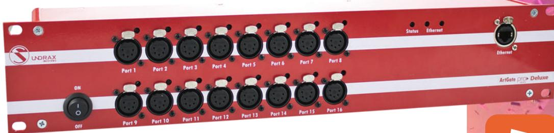
Artgate ist eine Reihe von Multifunktionsgeräten für bidirektionale DMX512-ArtNet / sACN Konvertierung. Von Artgate Arma empfangene DMX512 Datenströme werden über Ethernet-LAN in 10/100 Base-T-Modus und umgekehrt übertragen. Die Kompatibilität mit ArtNet und sACN Protokolle macht es einfach, ArtGates in Netzwerken mit Geräten anderer Hersteller zu integrieren. Deluxe Serie ist Sundrax Spezialität für 2-Einheit Rack ArtGates, lieferbar mit 12 oder 16 DMX-Ports.
