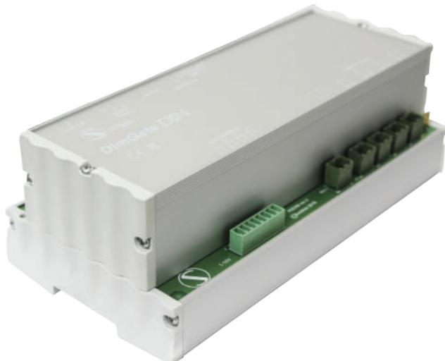
DimGate DIN ist ein Hybrid-Hutschienen-Dimmer, der das DMX512 Signal in 4 unabhängige 110-230 VAC Ausgänge mit bis zu 1,2 kW umwandelt, um das Dimmen von Glühlampen zu gewährleisten. Zusätzliche 4 separate 1-10V (oder 0-10V) Ausgänge werden mit Geräten mit 1-10V Dimmer Treiber und Elektronischen Vorschaltgeräten in DMX-gesteuerte Umgebungen integriert.
