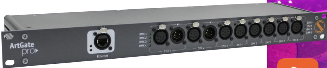
Artgate ist eine Reihe von Multifunktionsgeräten für bidirektionale DMX512-ArtNet / sACN Konvertierung. Von Artgate Arma empfangene DMX512 Datenströme werden über Ethernet-LAN in 10/100 Base-T-Modus und umgekehrt übertragen. Die Kompatibilität mit ArtNet und sACN Protokolle macht es einfach, ArtGates in Netzwerken mit Geräten anderer Hersteller zu integrieren. Deluxe Serie ist Sundrax Spezialität für 2-Einheit Rack ArtGates, lieferbar mit 12 oder 16 DMX-Ports.
