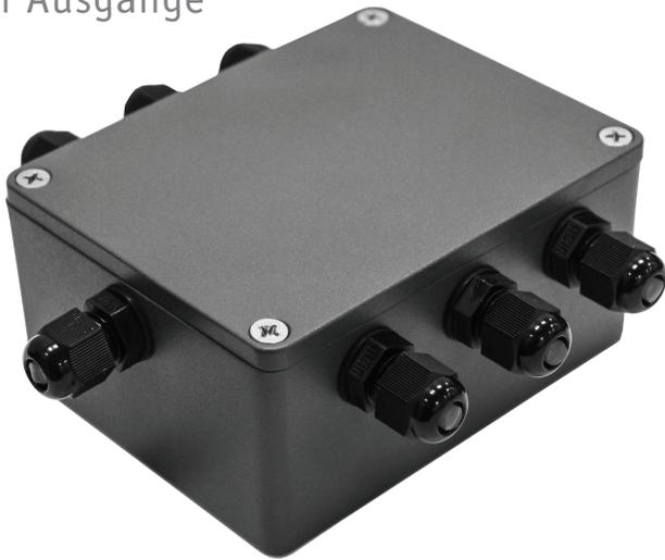
Splitter Arma DUO ist ein Ein-Kanal-DMX-512-Repeater mit Ausgänge. Alle Ein und Ausgangskanäle sind miteinander galvanisch getrennt. Das Gerät ist geeignet für den Außenbereich und hat das höchste Niveau von Staub und Feuchtigkeit Schutz. Versorgungsspannung von 90-250V AC Industrie Netzbetrieb, der Stromverbrauch ist geringer als 5 Watt. Eingang, Ausgang, DMX-Kabel und das Netzkabel werden über Kabelverschraubungen mit den Gerätekörper verbunden.
