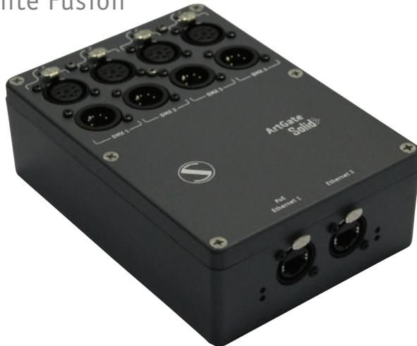
ArtGate ist eine Reihe von Multifunktionsgeräten für die bidirektionale DMX512-ArtNet / sACN-Konvertierung. Die von ArtGate Solid empfangenen DMX512-Datenströme werden über Ethernet LAN im 10/100 Base-T-Modus und umgekehrt übertragen. Die Kompatibilität mit ArtNet- und sACN-Protokolle macht es einfach, ArtGates in Netzwerken mit Geräten anderer Hersteller zu integrieren.
