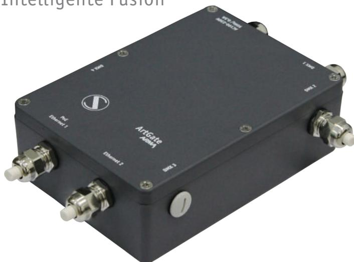
ArtGate ist eine Reihe von Multifunktionsgeräten für die bidirektionale DMX512-ArtNet / sACN-Konvertierung. Die von ArtGate Arma empfangenen DMX512-Datenströme werden über Ethernet LAN im 10/100 Base-T-Modus und umgekehrt übertragen. Die Kompatibilität mit ArtNet- und sACN-Protokolle macht es einfach, ArtGates in Netzwerken mit Geräten anderer Hersteller zu integrieren.
