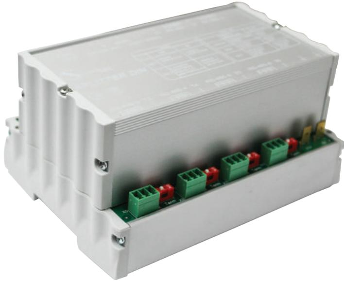
Splitter DIN DUO ist ein spezielles DIN-Schienenmontage Gerät mit 6 DMX-Ein- / Ausgängen, das als regulärer Splitter mit 1 Eingang und 5 Ausgängen sowie zwei getrennten 1-zu-2 Splittlern arbeitet. Alle Eingangs- und Ausgangskanäle sind voll galvanisch getrennt. Remote Device Management (RDM) kompatibel. Das Gerät ist für den Innenbereich geeignet. Splitter werden von 100-250 V industriellen AC-Netz angetrieben, der Energieverbrauch ist kleiner als 5 Watt.
