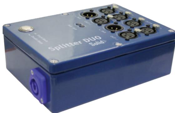
Splitter Solid DUO ist ein spezielles Gerät mit 2 DMX-Eingängen und 4 DMX-Ausgängen, das als regulärer Splitter mit 1 Eingang und 5 Ausgängen sowie zwei getrennten 1-zu-2-Splittern arbeitet. Alle Eingangs- und Ausgangskanäle sind voll galvanisch getrennt. Remote Device Management (RDM) kompatibel. Das Gerät ist für den Innenbereich geeignet. Splitter werden von 100-250 V industriellem Wechselstromnetz angetrieben, der Energieverbrauch ist kleiner als 5 Watt.
