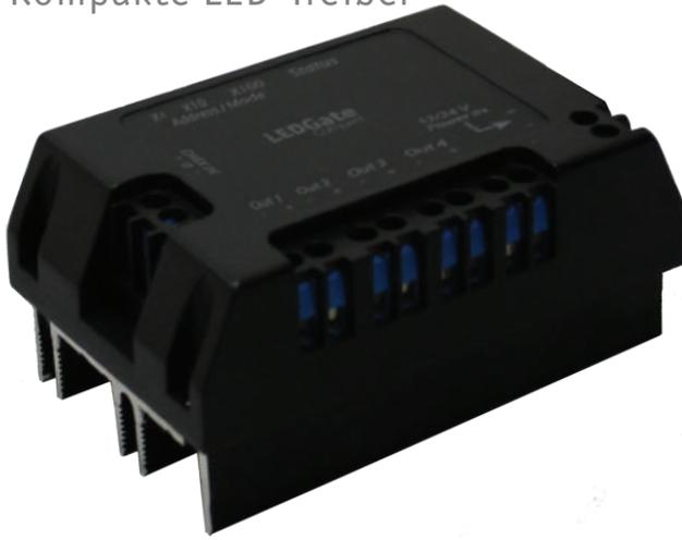
LEDGate Compact ist ein kompakt LED-Treiber mit DMX512-Eingänge. Betrieben von einer 12/24 VDC Quelle, ist LEDGate in der Lage zu kontrollieren und zu dimmen, 4 oder 8 Ausgangsleitungen für den direkten Anschluss mit LED-Ausstattung: Duralight, fahrerlose LED-Leuchten, etc, mit unabhängigen Kurzschluss Schutz für jeden Kanal. Dank innovativer Embedded-Algorithmen, sorgen LEDGates für eine reibungslose Regulierung in verschiedenen Intensitäten.
