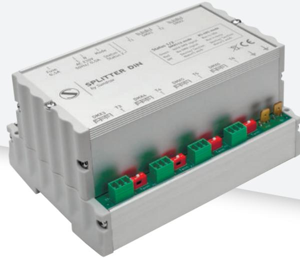
Splitter DIN DUO es un dispositivo especial en montaje carril DIN con 6 puertos de entrada/salida DMX que opera como un splitter normal con 1 entrada y 5 salidas, o también funciona como dos splitters separados. Todos los canales de entrada y salida disponen de aislamiento galvánico. Compatible con Gestión Remota de Dispositivos (RDM). El dispositivo es apto para uso interior. Los splitters están alimentados por una red industrial AC de 100-250V y consumen menos de 5 vatios de potencia.
