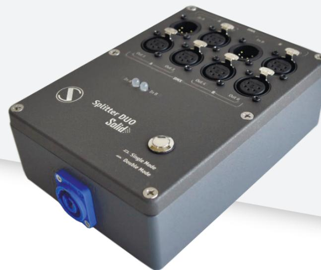
Splitter Solid DUO es un dispositivo especial con 2 entradas DMX y 4 salidas DMX que opera como un splitter normal con 1 entrada y 5 salidas, o también funciona como dos splitters separados. Todos los canales de entrada y salida disponen de aislamiento galvánico. Compatible con Gestión Remota de Dispositivos (RDM).
