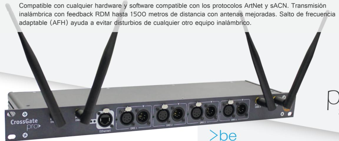
Convertor híbrido DMX ArtNet/sACN en montaje de rack usando la red Ethernet LAN en modo 10/100 Base-T para transmitir la señal DMX y proveer excelente respaldo a través de los canales inalámbricos 2.4 GHz. Opción inteligente para ir de gira como un dispositivo de repuesto que cubre ambas tecnologías de transmisión. Diversos modos de fusión disponibles: HTP, LTP, AUTO, PRIORITY, OVERLAY.
