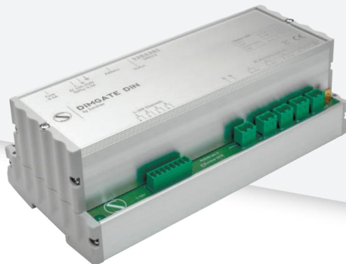
DimGate DIN es un regulador híbrido en carril DIN que convierte señal DMX512 en 4 salidas independientes 110-230 VAC de hasta 1.2 kW cada una para gestionar la regulación de lámparas incandescentes. Se suministran 4 salidas adicionales de 1-10V (o 0-10V) para integrar dispositivos con controladores de atenuación de 1-10V y balastos electrónicos en entornos controlados por DMX.
