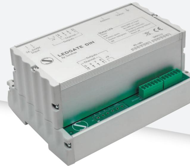
LEDGate DIN es un driver LED compacto con entrada DMX512/RS-485. Alimentado por una fuente VDC 12/24, LEDGate es capaz de controlar y regular 4 u 8 líneas de salida para una conexión directa con equipos LED: duralight, luminarias LED driverless, etc. con protección independiente contra cortocircuitos en cada canal. Gracias a los innovadores algoritmos integrados, los LEDGates proporcionan una regulación uniforme y progresiva en toda la gama de intensidad. Sin parpadeos.
