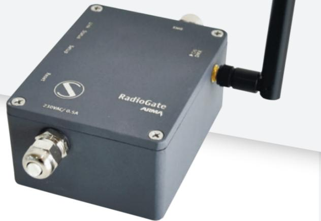
Proveen imparable comunicación DMX bidireccional entre dispositivos en 2.4 GHz ISM con RDM feedback hasta 1500 metros con antenas mejoradas. Salto de frecuencia adaptable (AFH) ayuda a evitar disturbios de cualquier otro equipo inalámbrico. Todos los Radiogates son versátiles transmisor +receptor, con un botón de configuración.
