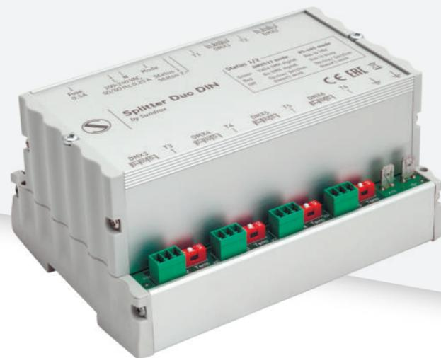
Splitter DIN DUO es un dispositivo especial en montaje carril DIN con 6 puertos de entrada/salida DMX que opera como un splitter normal con 1 entrada y 5 salidas, o también funciona como dos splitters separados. Todos los canales de entrada y salida disponen de aislamiento galvánico. Compatible con Gestión Remota de Dispositivos (RDM). El dispositivo es apto para uso interior. Los splitters están alimentados por una red industrial AC de 100-250V y consumen menos de 5 vatios de potencia.
