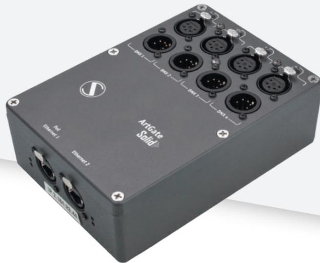
Convertidor multifuncional que interpreta los protocolos Ethernet (ArtNet, sACN) a DMX para controlar más instalaciones de luces a través de la red Ethernet LAN en modo 10/100 Base-T.
