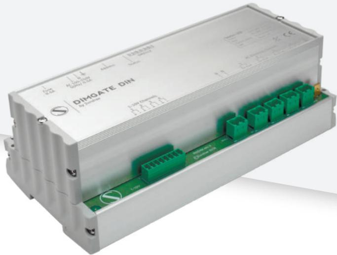
DimGate DIN es un regulador híbrido en carril DIN que convierte señal DMX512 en 4 salidas independientes 110-230 VAC de hasta 1.2 kW cada una para gestionar la regulación de lámparas incandescentes. Se suministran 4 salidas adicionales de 1-10V (o 0-10V) para integrar dispositivos con controladores de atenuación de 1-10V y balastos electrónicos en entornos controlados por DMX.
