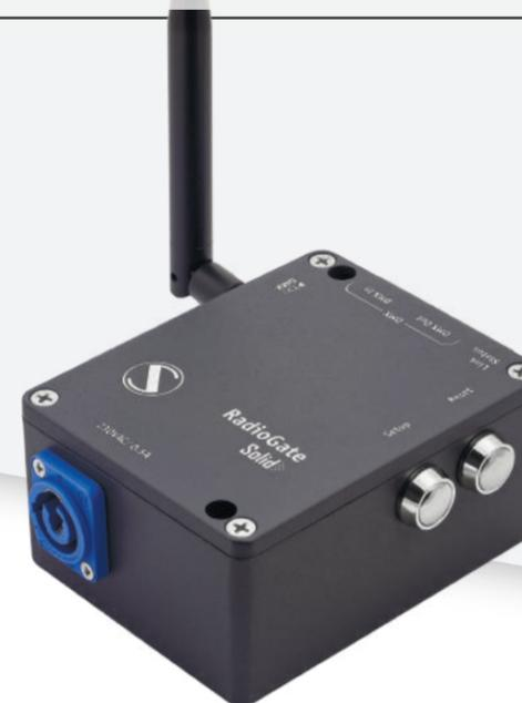
Proveen imparable comunicación DMX bidireccional entre dispositivos en 2.4 GHz bidireccional ISM con RDM feedback hasta 1500 metros con antenas mejoradas. Salto de frecuencia adaptable (AFH) ayuda a evitar disturbios de cualquier otro equipo inalámbrico. Todos los Radiogates son versátiles transmisor +receptor, con un botón de configuración.
