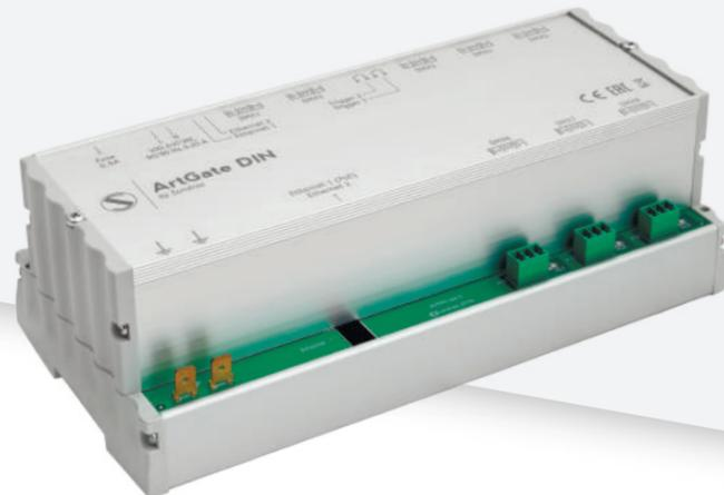
Convertidor multifuncional en montaje DIN que interpreta los protocolos Ethernet (ArtNet, sACN) a DMX para controlar más instalaciones de luces a través de la red Ethernet LAN en modo 10/100 Base-T.
